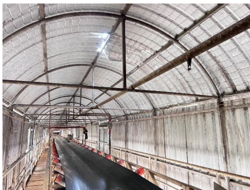
รูปที่ 9 ฝาครอบและหัวฉีดน้ำ บริเวณสายพานลำเลียงชานอ้อย
